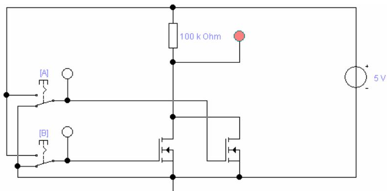
NOR-Verknüpfung mit NMOS-Transistoren
