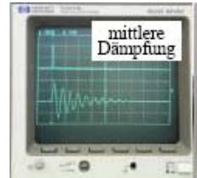
Befindet sich ein Widerstand im Schwingkreis, wird die Schwingung gedämpft, d.h. die Amplitude verringert sich mit der Zeit.
