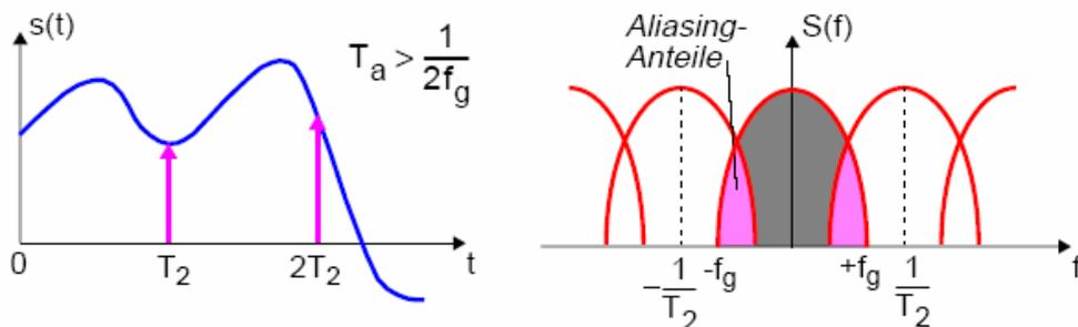
⇒ **Aliasing-Frequenzen** sind Frequenzen, die durch Abtasten auf die gleiche Frequenz abgebildet werden
