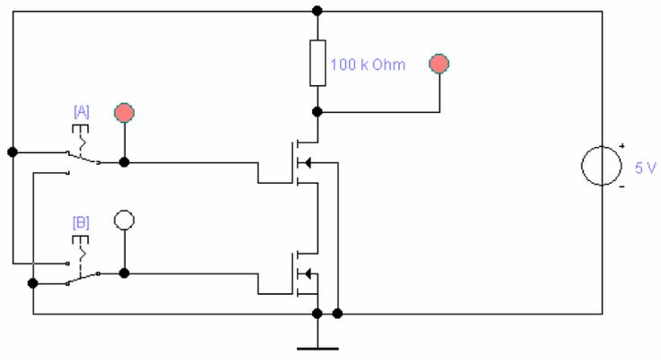
NAND-Verknüpfung mit NMOS-Transistoren
