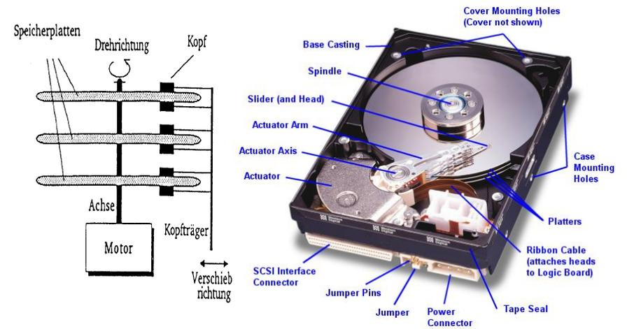
Schematischer Aufbau einer Festplatte
