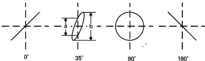
Die Berechnung des Phasenwinkels oder der Phasenverschiebung zwischen den X- und Y-Eingangsspannungen (nach Messung der Strecken **a** und **b** am Bildschirm) ist mit den folgenden Formeln und einem Taschenrechner mit Winkelfunktionen ganz einfach und übrigens **unabhängig von den Ablenkamplituden** auf dem Bildschirm.
