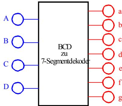
Der Siebensegmentdekoder liefert für die Werte AH ... FH folgende Zeichen auf der 7-Segment-Anzeigeeinheit:
