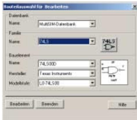
3. Aus der Liste Name im Bereich Datenbank wählen Sie die Quelldatenbank, aus welcher ein Bauteil bearbeitet werden soll. Typischerweise ist dies die "Multisim-Datenbank".
