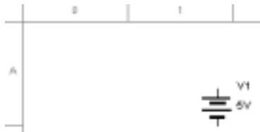
Die Textelemente (Bezeichner, Wert, Modellname), welche rund um ein Bauteilsymbol erscheinen, können bei Bedarf ausgeblendet werden. Um diese auszublenden, doppelklicken Sie das Bauteil. Das Fenster Bauteil "Eigenschaften" erscheint mit verschiedenen Registern. Unter dem Register Anzeige können Sie die gewünschten Einstellungen verändern.
