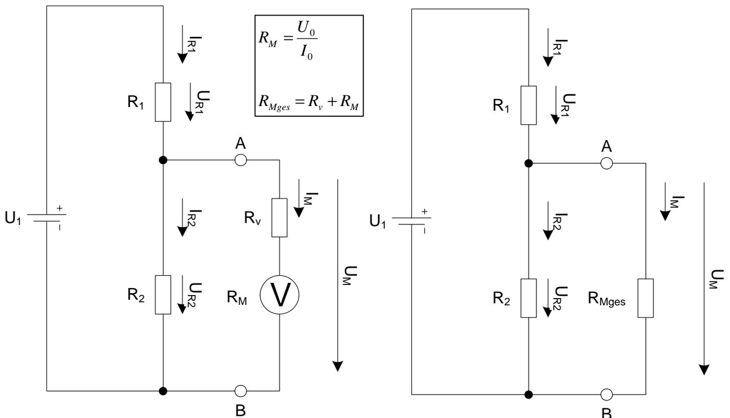
Bei Spannungsmessgeräten mit einem geringen Innenwiderstand kann es durch einen belasteten Spannungsteiler zu Fehlmessungen kommen.
