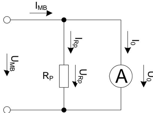
Das gleiche Zeigerinstrument soll als Strommessgerät verwendet werden.
