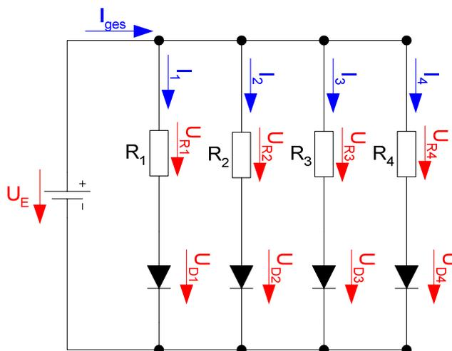
Die Dioden  $D_1$  bis  $D_4$  sollen an der Spannungsquelle  $U_E$  betrieben werden. Dabei fallen über die Dioden die Spannungen  $U_{AD1}$  -  $U_{AD4}$  ab.  $D_1$  ist die Silizium-Diode,  $D_2$  ist die rote Leuchtdiode,  $D_3$  ist die grüne Leuchtdiode,  $D_4$  ist die blaue Leuchtdiode.
