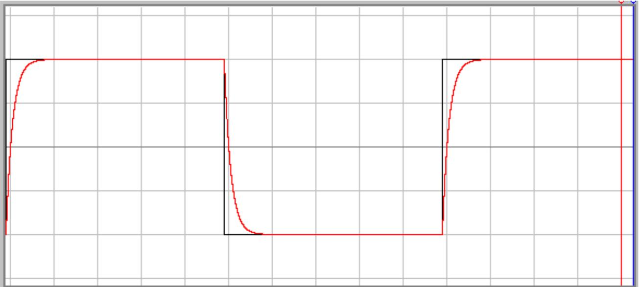
3.1.2. Frequenz  $f_1 = 1 \text{ kHz}$  -  $T = 1 \text{ ms}$  - 1Teilstrich entspricht 1V bzw. 100  $\mu\text{s}$
